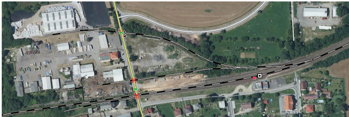
Obr. 4: Soutisk ortofotomapy s vybranými datovými vrstvami ZABAGED ® a tematickými daty o přejezdech na vlečkových drahách [12]
