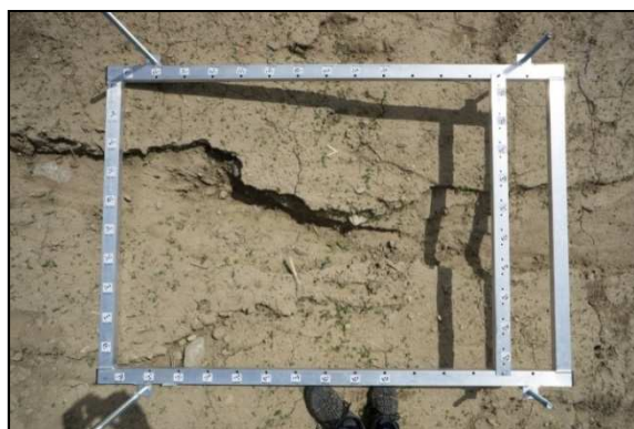
Obr. 3: Snímek pro vyhodnocení objemu erozní rýhy
