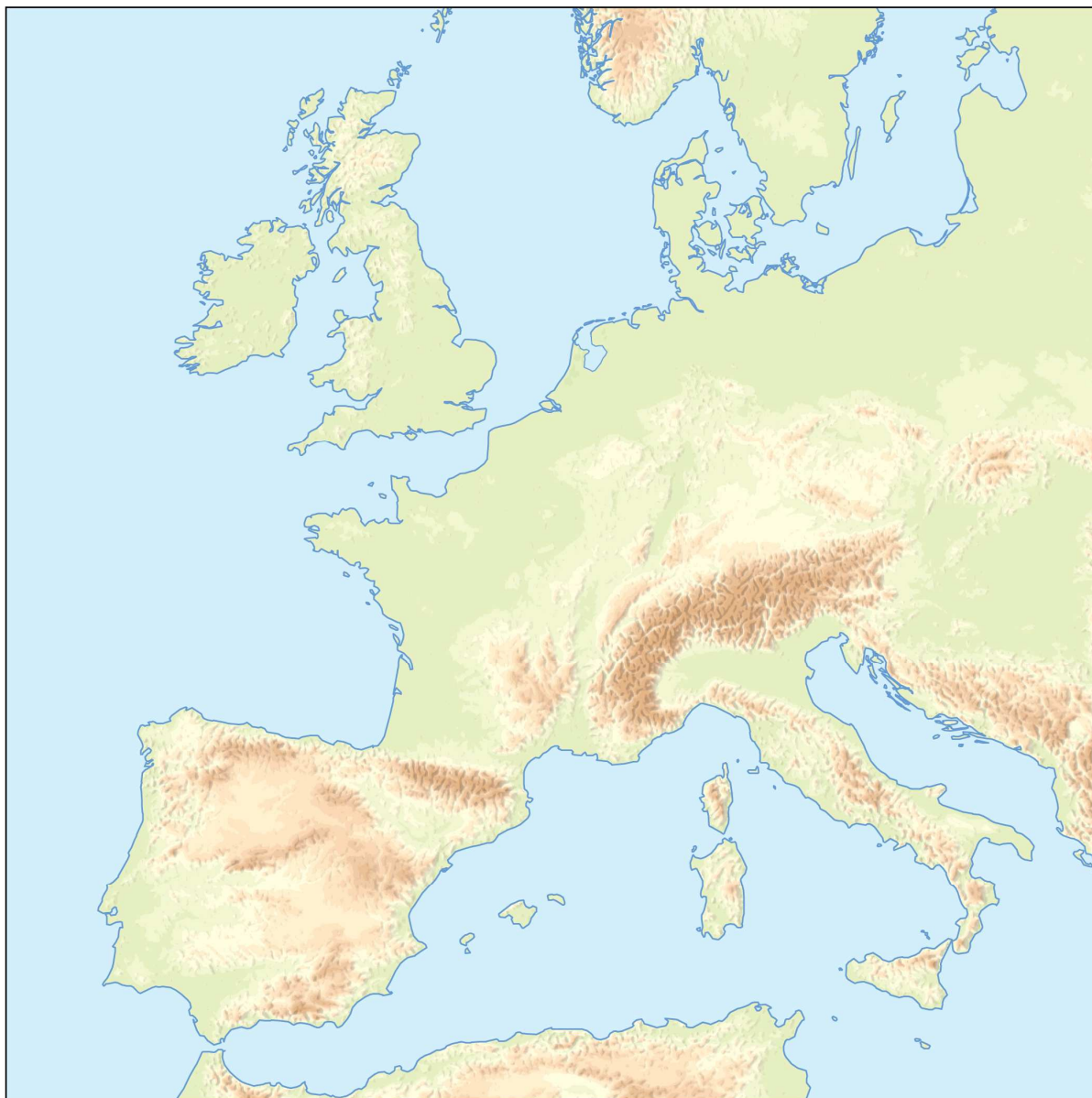
Obr. 4: Barevná hypsometrie v kombinaci se stínovaným reliéfem povrchu
