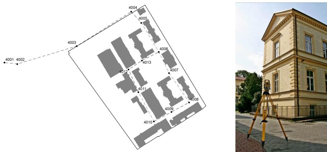
Obr. 2: Měřický náčrt stanovisek a použitá totální stanice před budovou Geografického ústavu
