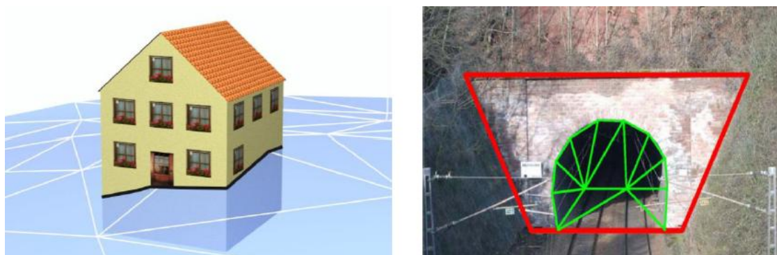
Obr. 4: Použití TerreinIntersectionCurve (vlevo černá křivka, vpravo červená) a ClosureSurface – zelený povrch vpravo (převzato z [4])
